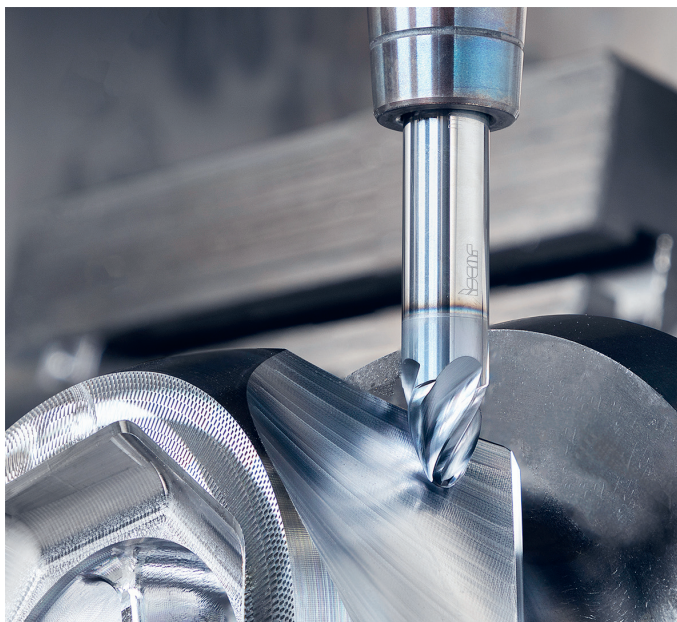
Obr. 1 – Monolitní karbidová kuželová soudečková fréza SC ETB pro pětiosé 3D tvarové obrábění
