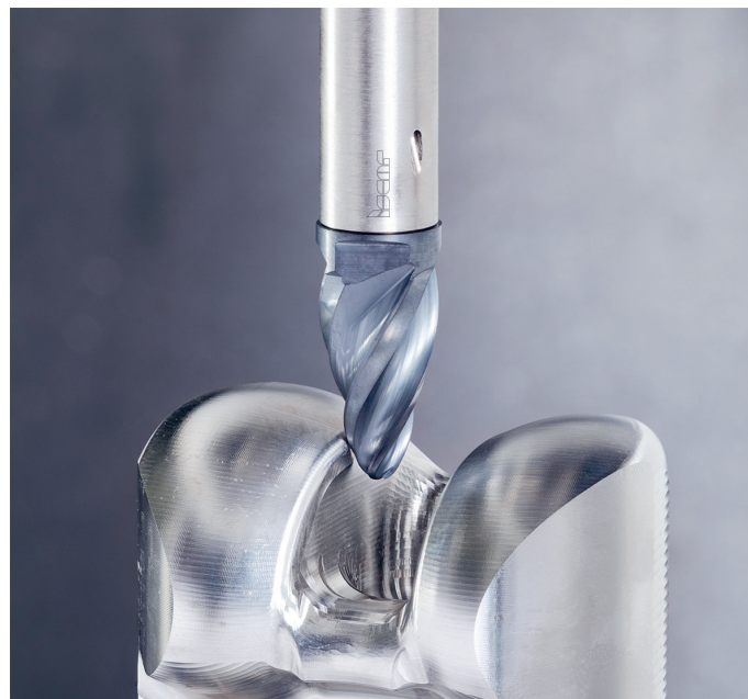
Obr. 2 – Ekonomická varianta soudečkové oválné frézy MM EOB v systému MULTI-MASTER s vyměnitelnou karbidovou hlavici
